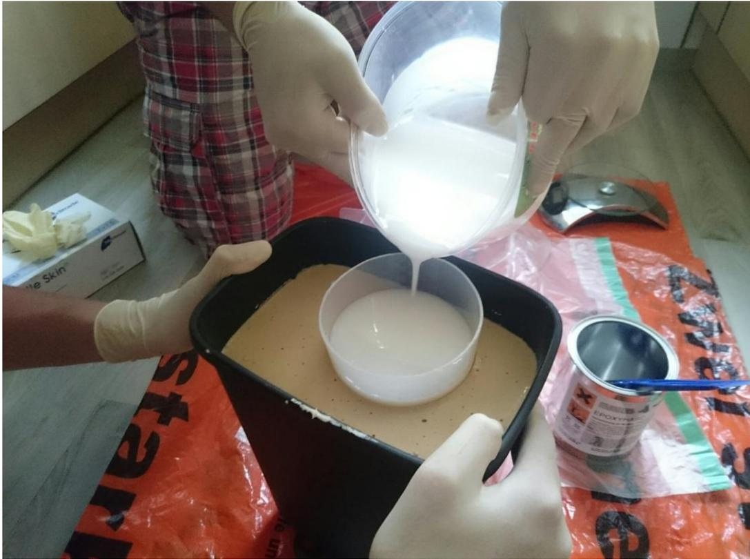
Abbildung 35: Prototyp III - Epoxidharz Gießverfahren
