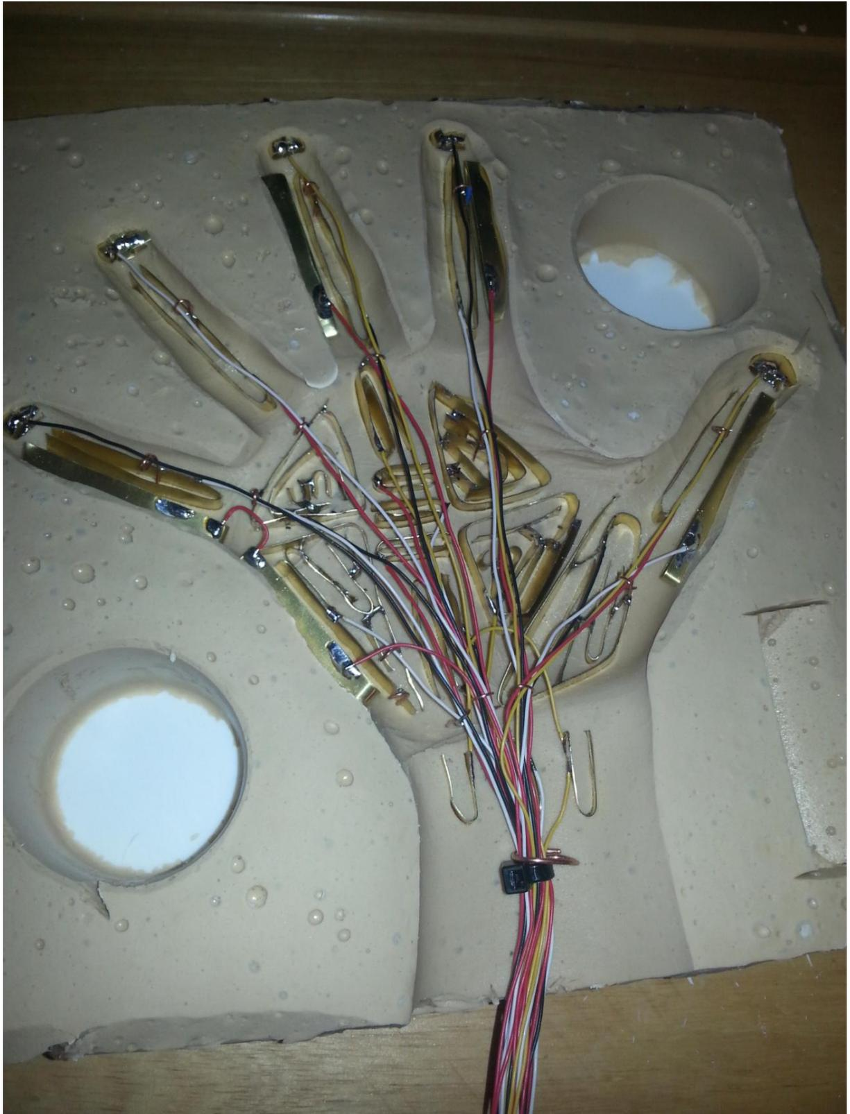
Abbildung 26: Prototyp II Alginate verdrahtet
